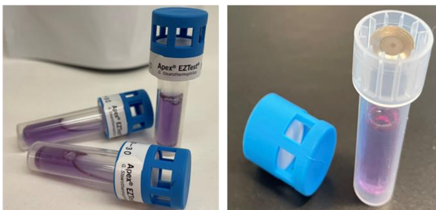
図 1. Apex EZTest バイオロジカルインジケーター (右の画像は芽胞ディスクの位置を示しています)
