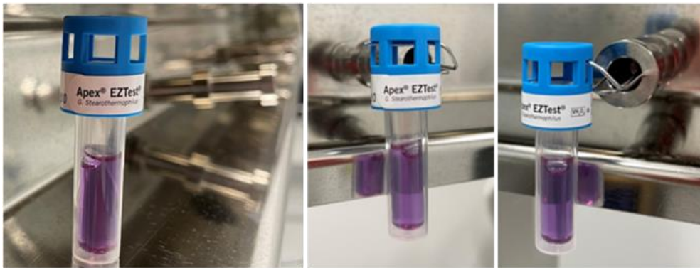
図 4. Apex EZTest BI の設置 (立てて設置、固定器具に吊るして設置した例)
